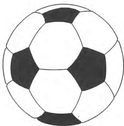
図 サッカーボールとC 60 の分子構造。C 60 分子は、このボールの60個の頂点を炭素原子で置き換えた形をしている。
