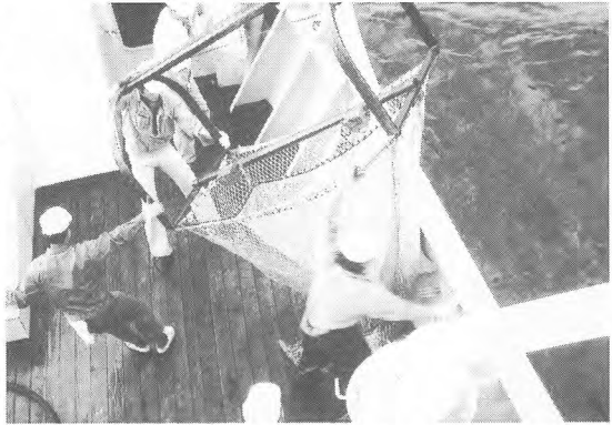
大型ベントスを採集する鉄の機をつけたビーム・トロール
